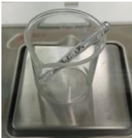
Figura 8.- Liner con muestra de PM<sub>10</sub>.
